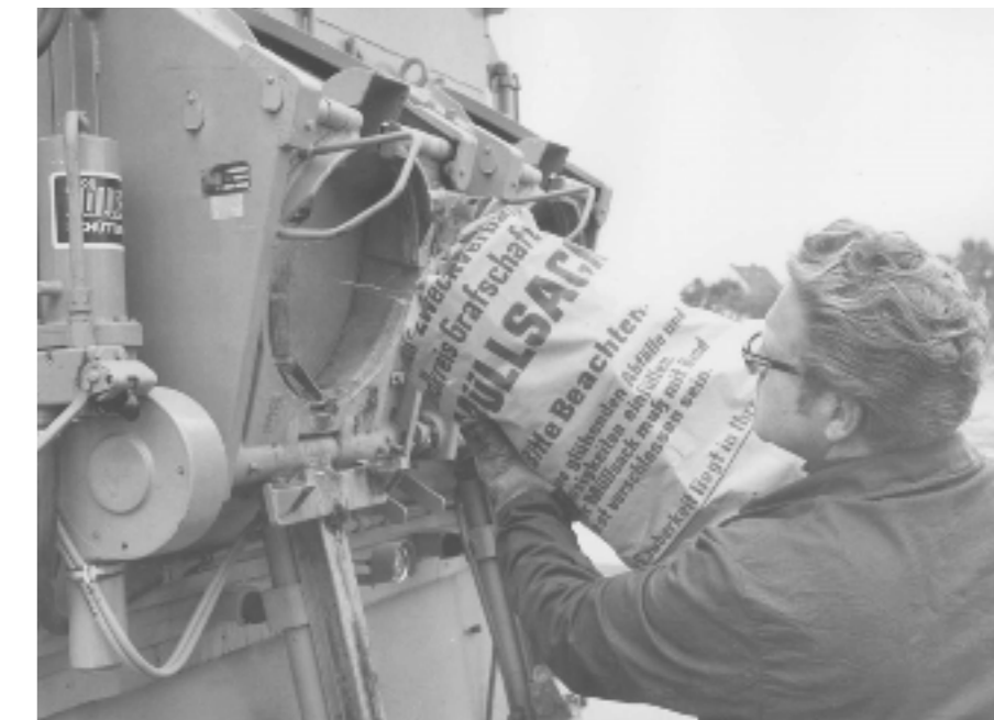
Für zusätzlich anfallenden Hausmüll wurden Papiertüten bereitgestellt, maßgeschneidert für die Kippvorrichtung der beiden neubeschafften Spezialfahrzeuge.
