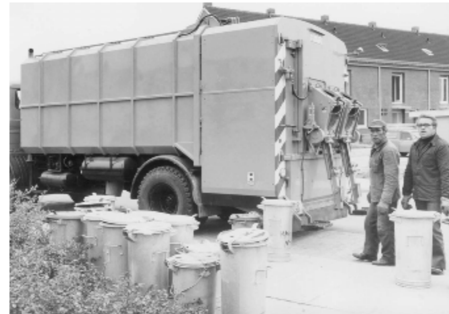
Pressefoto Oktober 1972: Eines der beiden modernen Müllfahrzeuge des MZV, deren Schüttung ohne große Schwierigkeiten innerhalb weniger Minuten auch für die Entladung von Großbehältern umgewandelt werden kann.
