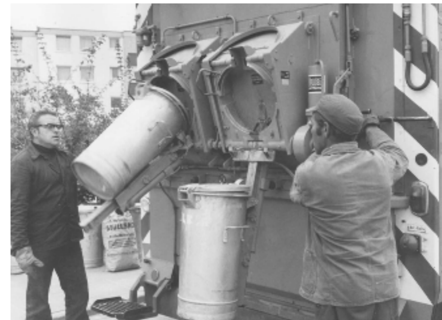
Im Oktober 1972 demonstrieren neu angestellte Mitarbeiter gegenüber der Presse, wie die staubfreie Entleerung funktioniert.
